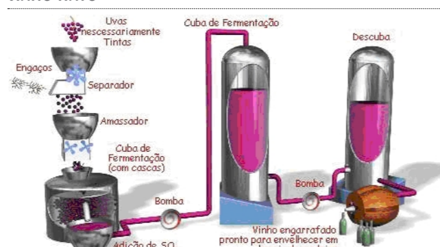
FIGURA 2 - FLUXOGRAMA DO PROCESSO DE FABRICAÇÃO DO VINHO TINTO
